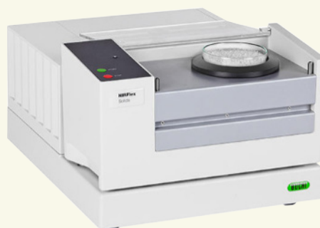
Figura 3. Spettrometro NIRFlex 500 solids, Buchi regione spettrale 10.000 - 4000 cm -1 , con petri e campione solido.
